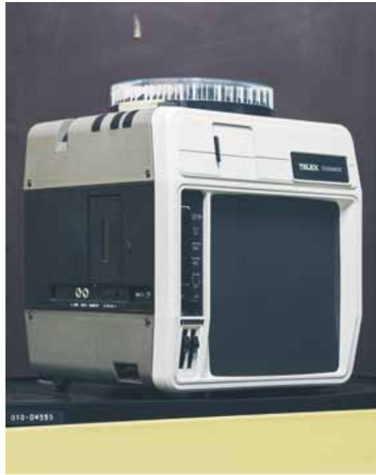
Telex caramate 4000, película de 35 mm. Proyector de diapositivas con pantalla de 12" y con reproductor de cintas de audio. Este último, consistía en un monitor a través del cual se mostraban las diapositivas. Fotografía Bruno Giliberto, 2017.
