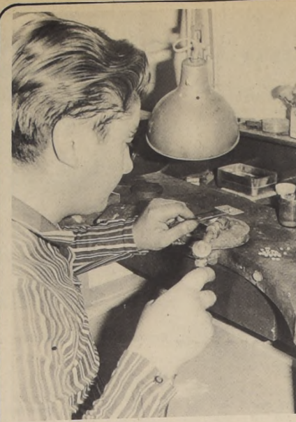
PARTE DEL PROCESO: El soldador junta las piezas que formarán el anillo.
