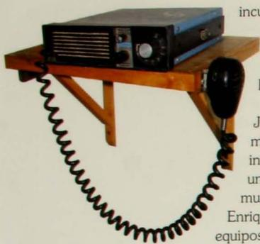
Equipo transmisor y receptor de VHF utilizado en el canal 16 para comunicaciones marinas entre naves y estaciones costeras
