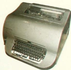
Teletipewriter de página "Cred" inglés utilizado en la transmisión y recepción de telegramas por ondas de radios, conocido como teletipos. Operó en las comunicaciones entre Punta Arenas y Santiago desde 1960 hasta 1970 (Museo Postal Telegráfico de Chile)
