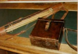
Aparatos telefónicos y sus complementos (varillas de enganche) utilizados para reparación de líneas por los guahachilos
