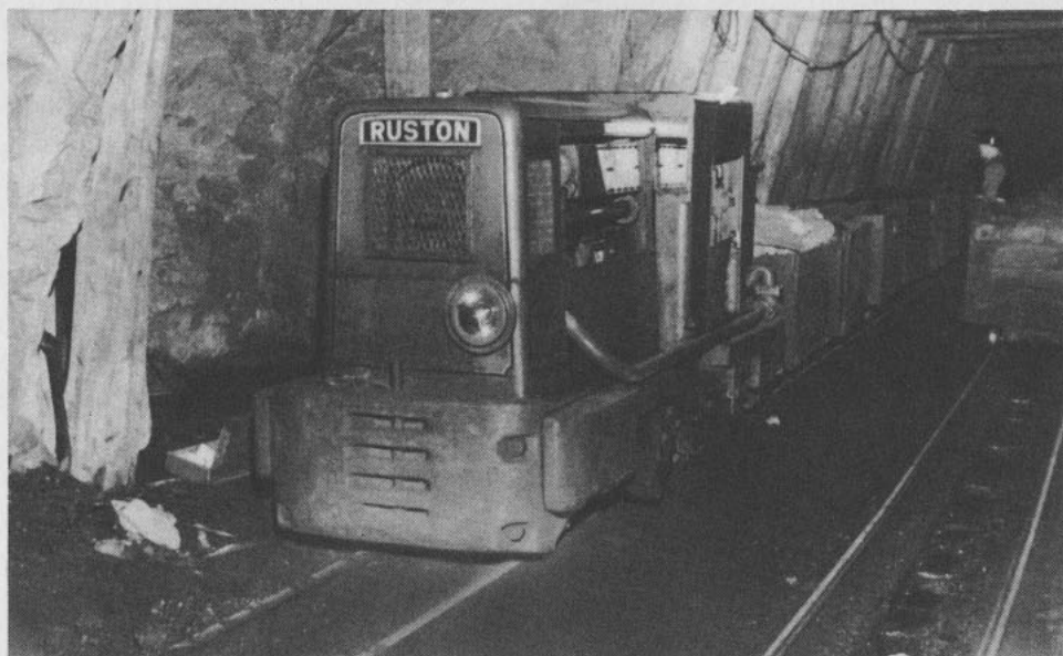
Locomotoras eléctricas para el transporte de carbón en el interior de los Piques.
