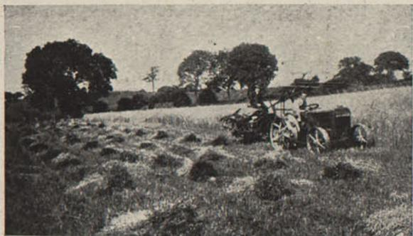
Con guardabarros, polea, regulador, magneto alta tensión, lubricación forzada, tiro ancho, frenos, resorte delantero y carburador Zenith.
