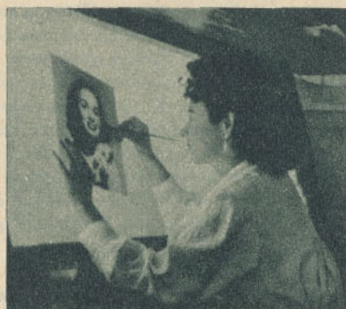
Retoque de positivos para el sistema de rotograbado.
