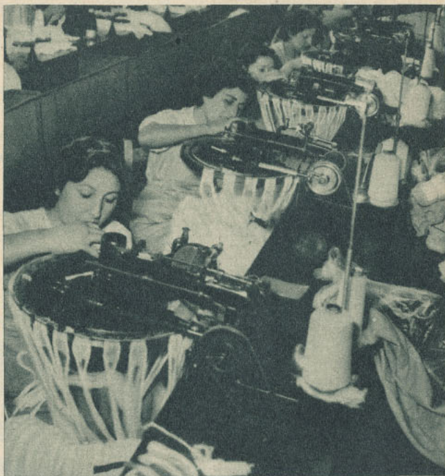
Sección Remallado. Máquinas dedicadas especialmente a coser las puntas de las medias.
