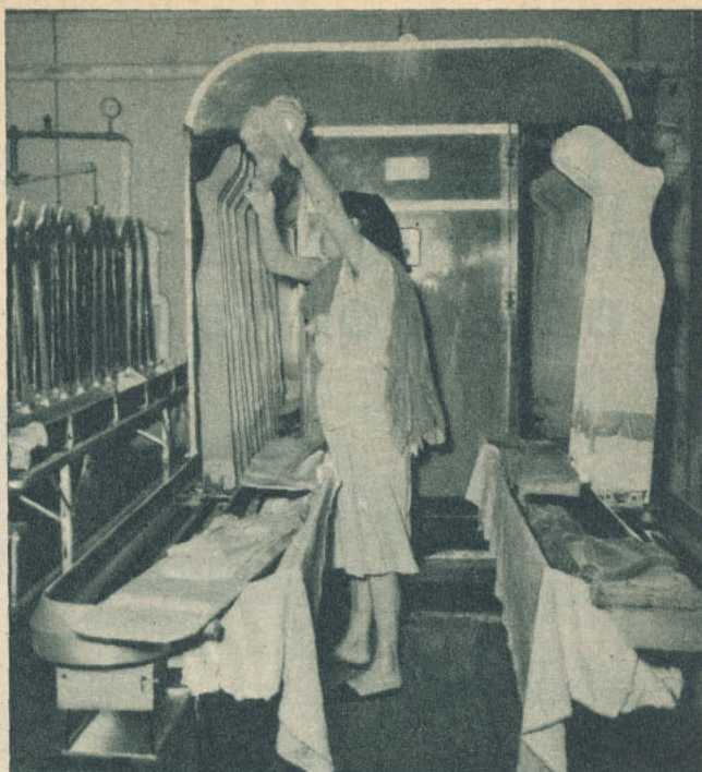
Vista parcial de la Sección Plancha. La fotografía ilustra la máquina planchadora, cuyo proceso es totalmente automático, ya que la única labor desarrollada por la operaria es poner y sacar las medias de los moldes.
