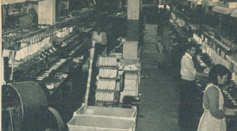
Un aspecto del Taller de canetes, donde se prepara el hilado que pronto habrá de ser colocado en los telares para la elaboración del rayón.
