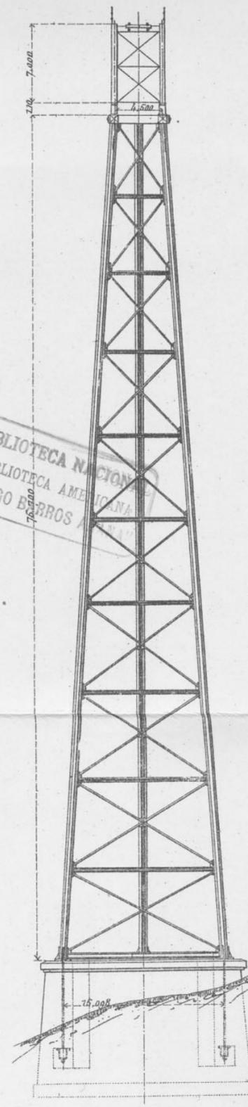
Fig.6. Elevacion de una pila metálica (Escala 1/400)
