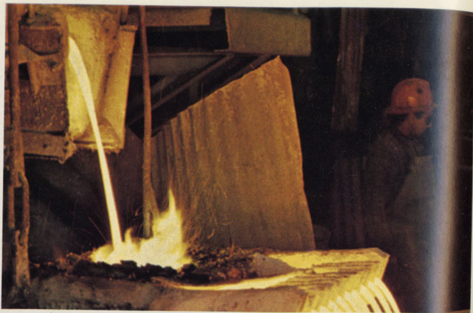
Molde de cobre refinado a fuego en lingotes 99,92 % cobre fino, en Caletones
