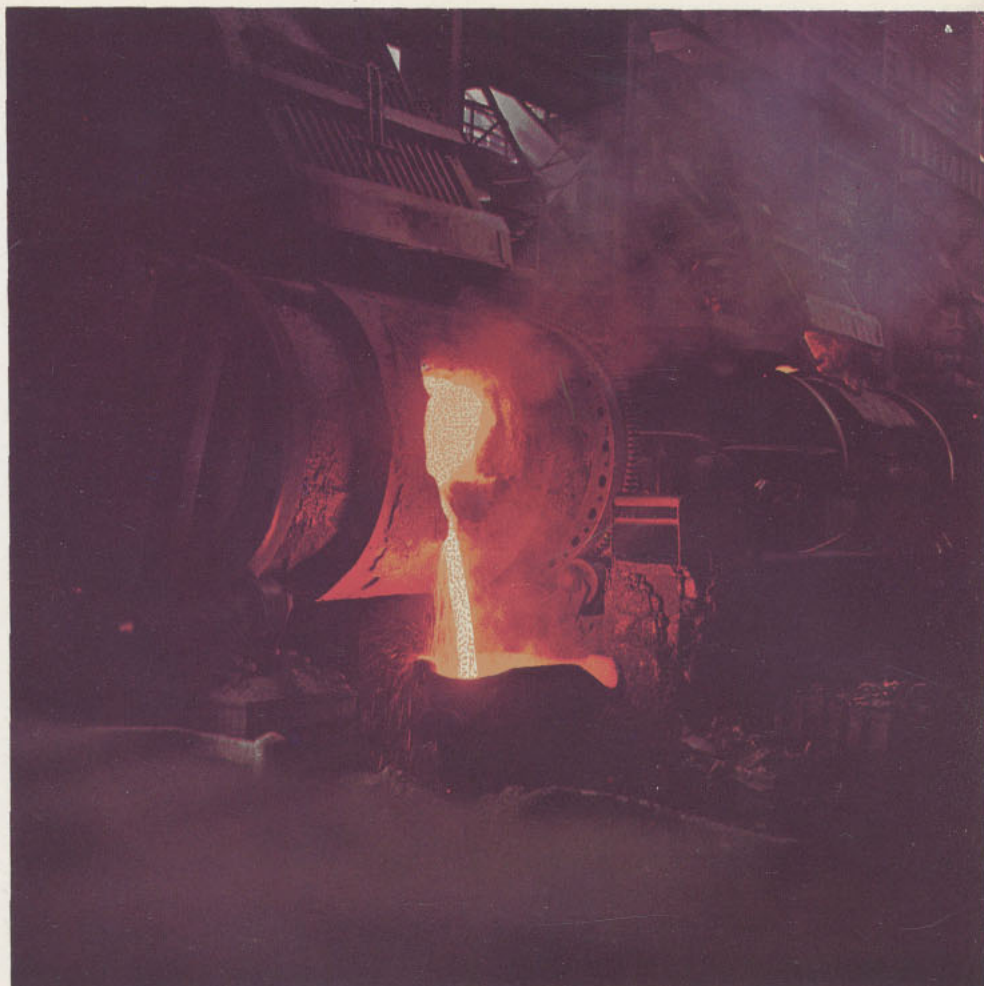
La Fundición de la Planta de Sulfuros: brilla el fuego del horno y el candente chorro de cobre líquido que cae en una de las «ollas» o depósitos que lo transportan a otras etapas del proceso, en Chuquicamata
