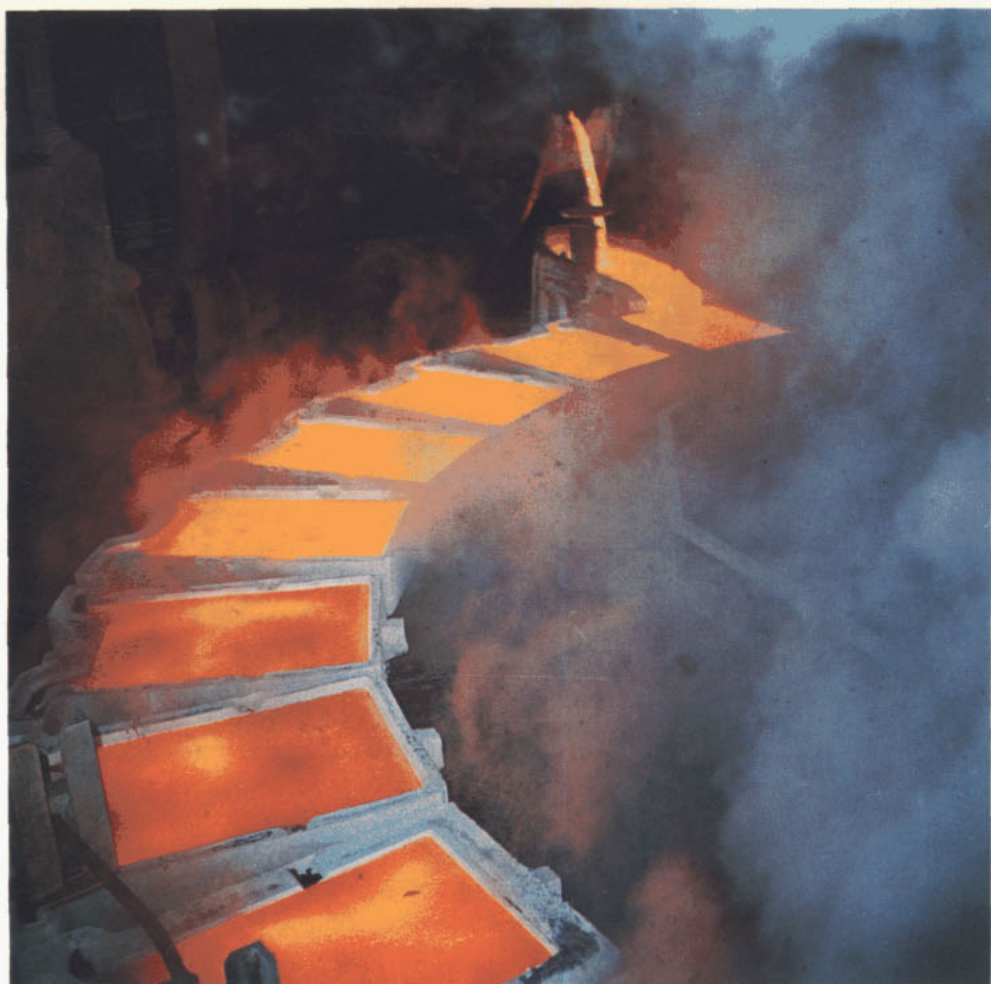
El cobre colocado en los moldes de la rueda giratoria, esta vez en forma rectangular, todavía candente, resplandece en sus depósitos, mientras sigue cayendo el chorro fundido al seno del horno, para llenar los otros moldes que va presentando la rueda al continuar su rotación, en Chuquicamata
