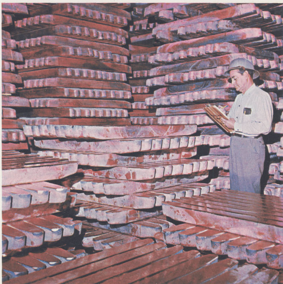
Los castillos formados por las barras de cobre, colocados junto a las líneas ferroviarias que penetran en la fundición de la Planta de Óxidos, están listos para ser subidos a los vagones que los llevarán al puerto de Antofagasta
