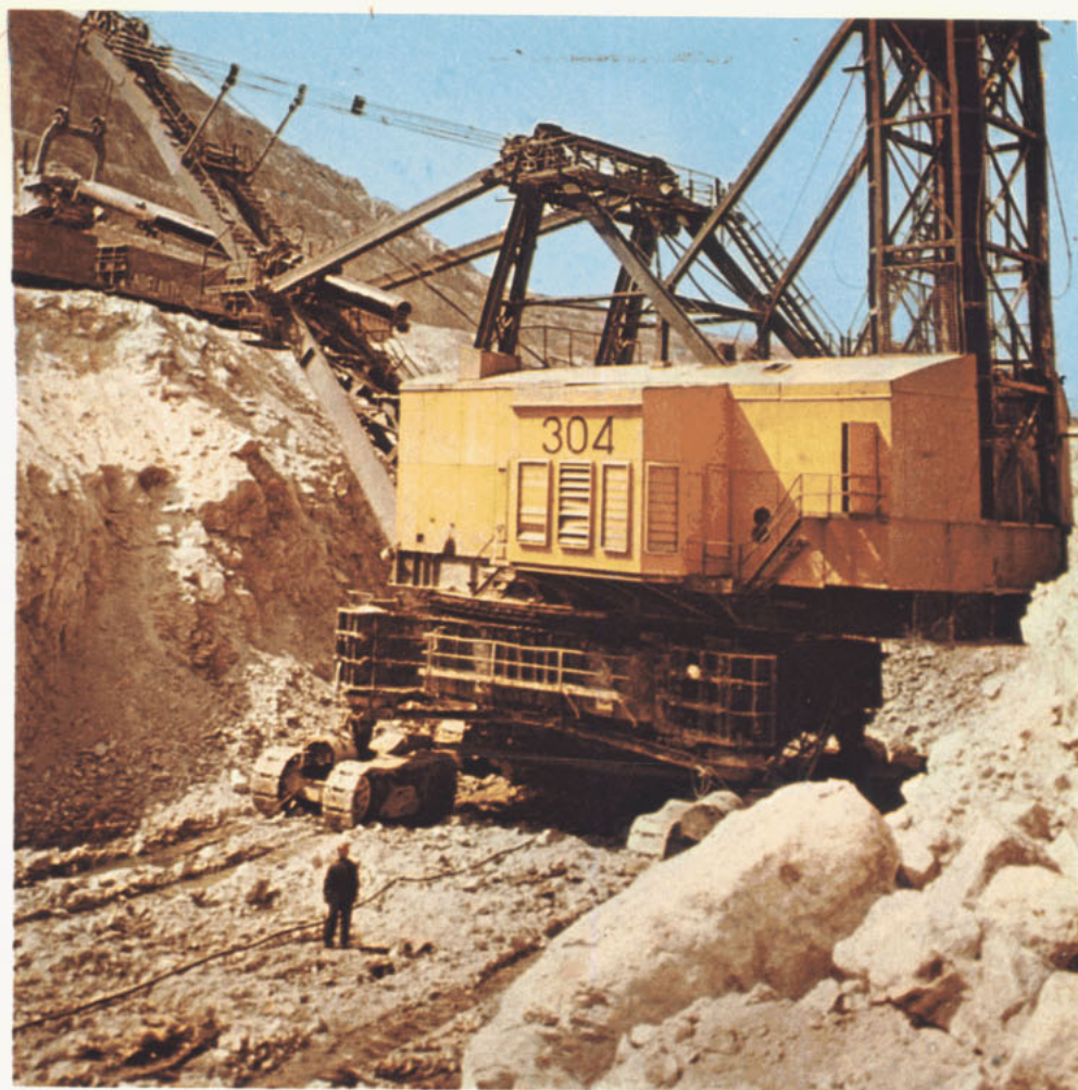
La pala mundial, en la acción de recoger el mineral removido por la explosión y de colocarlo en los carros que habrán de llevarlo a los molinos, en Chuquicamata
