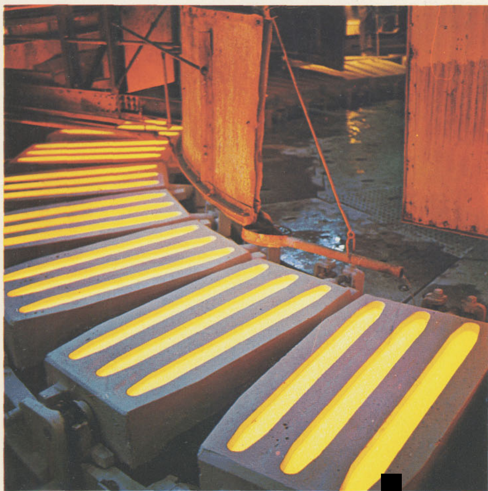
En la Planta de Óxidos: la rueda giratoria cuyos moldes reciben el líquido en el momento de «sangrar» los hornos de la Fundición, con el objeto de que el metal adquiera alguna de las formas en que habrá de exportarse, es la última etapa del proceso metalúrgico, en Chuquicamata
