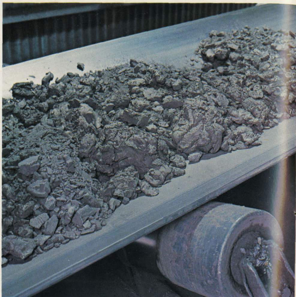
El mineral es transportado por correas desde los puntos de extracción a los piques y Planta de Chancado y desde allí a la Planta de Tratamiento, ubicada a más de cinco kilómetros de distancia. Cía. Minera Andina, S.A., en Río Blanco
