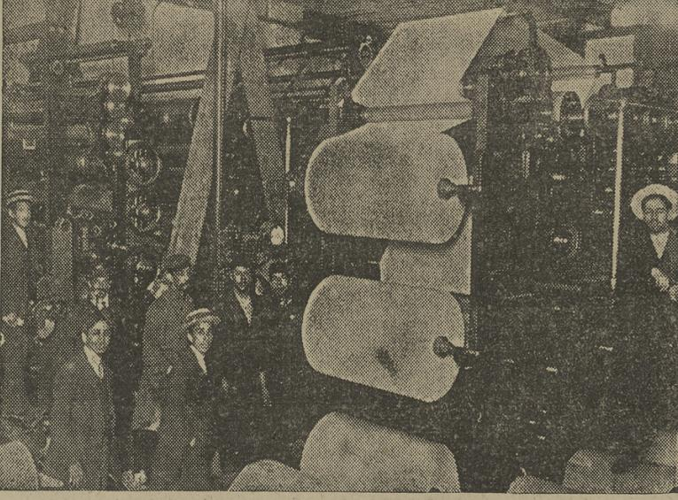
La colocación de rollos de papel, uno frente á cada serie de cilindros impresores
