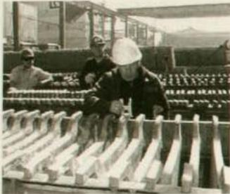
Estrictas Inspecciones de Calidad son realizados en distintas etapas del proceso productivo. Control de Ánodos, midiendo el espesor de las orejas de los ánodos comerciales.
