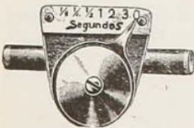
Interesante instrumento—especie de válvula—que se intercala en cualquier parte del tubo de goma entre la pera y la perilla de presión. Disparado el obturador, la válvula deja escapar el aire con más ó menos lentitud, haciendo que la perilla de presión no pueda aplanarse, (el obturador no puede cerrarse) sino al cabo de cierto tiempo. Estos
