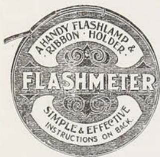
El «Flashmeter» de Johnson es admirable para ello. Es una cajita de lata que contiene un rollo de cinta de magnesio, cuya extremidad sobresale por una hendidura. La orilla de la caja está graduada por pulgadas, permitiendo al tirarse la cinta, de medir con exactitud el largo de cinta deseado. Se prende fuego en la extremidad y la cinta quema hasta la hendidura, donde por falta de aire se apaga sola. Las exposiciones que se dan con este ingenioso aparatito son pues todas enteramente parejas.
