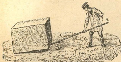
Fig. 12.—La palanca de primer género, dinarias, las tijeras, etc.
