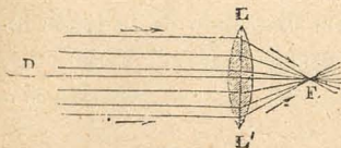
Fig. 135.—Convergencia de los rayos paralelos al eje.
