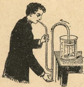
Fig. 67.—Carga del sifón con líquidos corrosivos.
