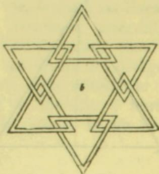
neas, dividiendo en tres los lados del octágono interior formado, y uniendo los puntos de la trisección, tendremos los triángulos entrelazados en *b*, figura 32.
