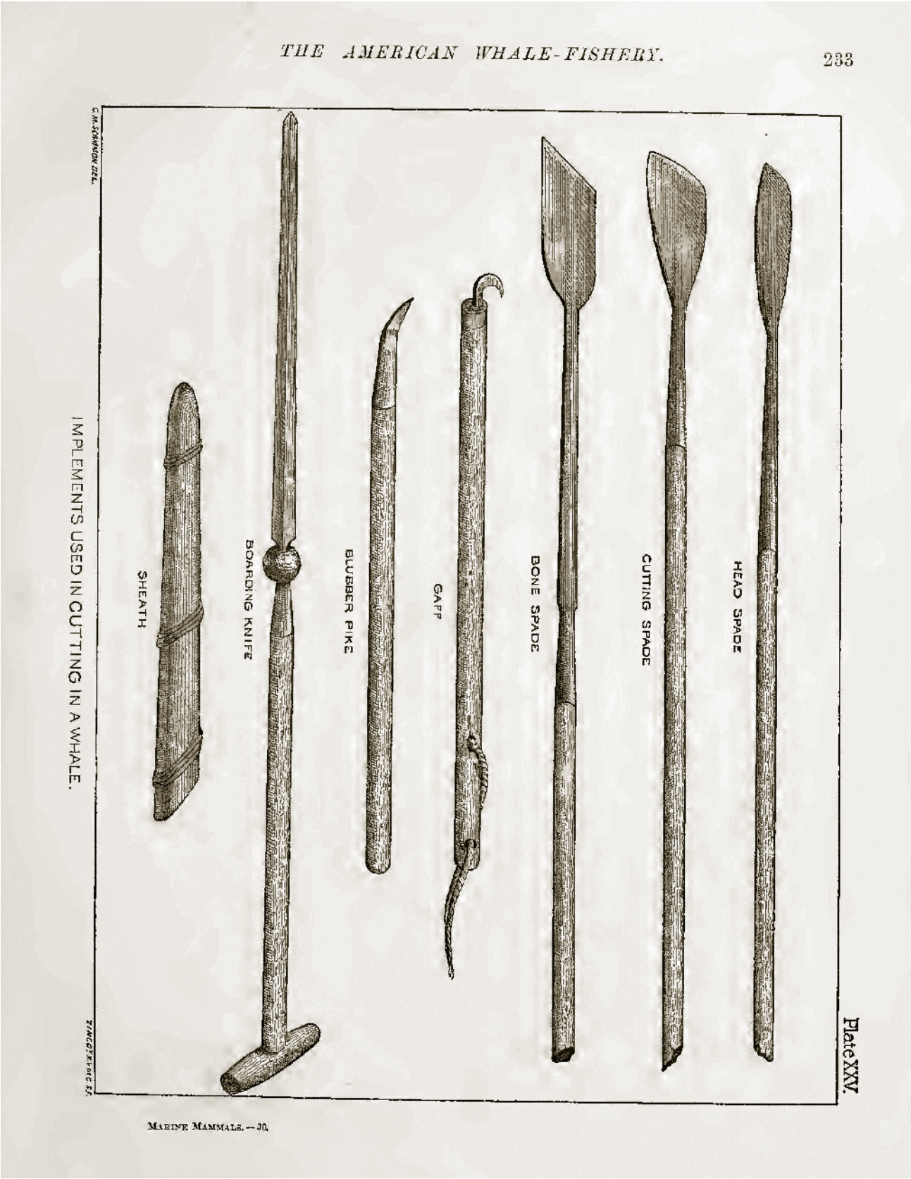
Figura 4: Implementos usados en el despiece de la ballena [en Scammon 1874]
