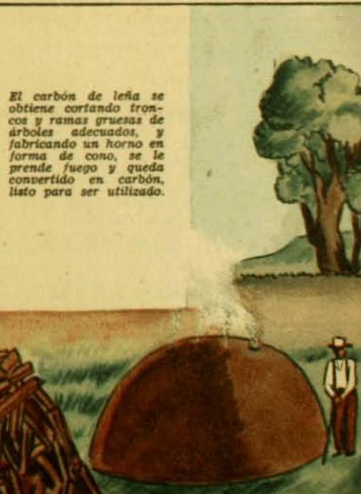
El carbón de leña se obtiene cortando troncos y ramas gruesas de árboles adecuados, y fabricando un horno en forma de cono, se le prende fuego y queda convertido en carbón, listo para ser utilizado.
