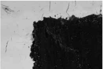
Foto 6: Ensayo de envejecimiento por HR y T. Microfotografía donde se aprecian grietas que han invadido la capa pictórica, en una muestra sin secativo de cobalto. Las grietas son debidas a los cambios dimensionales del soporte y no a la aplicación del secativo.
